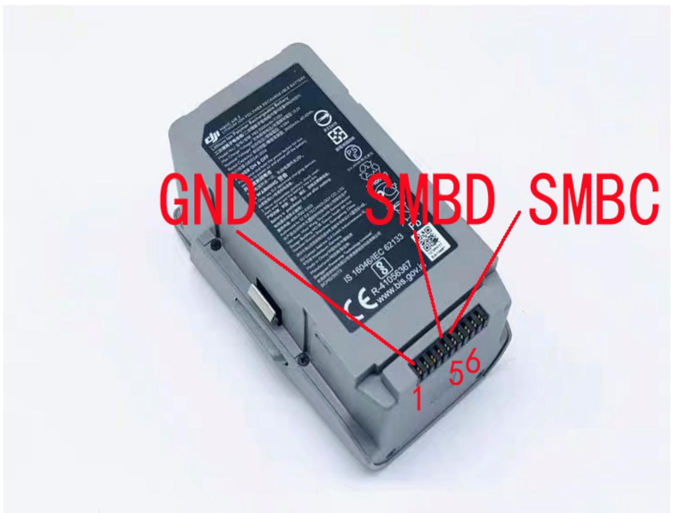
AIR2电池上通信定义如上图，接电池端口的GND, SmBD, SmBC。
